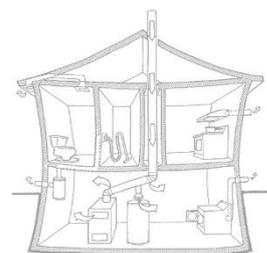
Prendre l'air pour la combustion à l'extérieur évite de prélever de l'air chaud, donc des calories dans la pièce où l'appareil est installé. Cela peut se faire par un conduit dédié qui alimentera le poêle directement,
